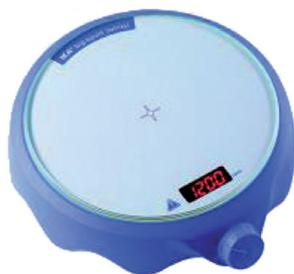
Agitateur magnétique à affichage numérique par LED de la vitesse et moteur à commande électronique. Le contrôle de la vitesse se fait par pas de 50 min<sup>-1</sup>. Les unités sont fabriquées à partir de matériaux recyclables. Très bonne résistance chimique grâce à la plaque en verre et au socle synthétique fait en polyamide. Moteur à commande électronique avec vitesse réglable en continu. Utilisables de 5 à 40°C (80 % d'humidité relative), dans un incubateur ou une chambre froide.
