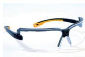
La monture double est très élastique. La partie avant est en polycarbonate, la partie arrière est en TPE plus souple. Elles sont extrêmement légères. Elles possèdent un pont nasal souple et les lentilles ont une excellente assise. Elles laissent passer 92% de la lumière et absorbent 99,9% des rayons ultraviolets jusqu'à 385 nm. Elles conviennent plus particulièrement à une utilisation dans les espaces intérieurs contre les dangers classiques connus.
