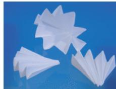
Papier filtre le plus fréquemment utilisé pour des applications générales. Papier filtre avec vitesse de filtration et capacité de rétention moyennes couvrant une large gamme d'applications en laboratoire. Il est souvent utilisé pour la clarification de liquides.
