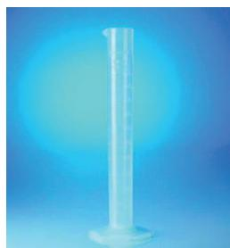
Très transparents. Conformes aux normes DIN 12681 et ISO 6706. Avec échelle graduée en relief, graduations circulaires aux points principaux et socle hexagonal. Ajuste sur "In". Charges thermiques à +60°C et non permanents dépassements de la limite de tolérance.
