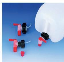
Se montent dans le bouchon à visser, afin d'assurer un dosage sûr et une bonne vidange du bidon. Robinets à boisseau en PE, s'ouvrant et se fermant aisément, avec un orifice d'aération. Ecoulement: Ø ext. de 22 mm.
