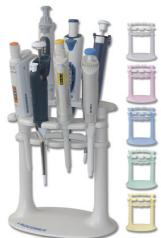
Modèle de table au design attractif, peu encombrant. Prévu pour sept pipettes monocanal de la plupart des marques. Polyamide solide et facile à nettoyer. Bonne stabilité grâce aux pastilles antidérapantes. Disponible en cinq coloris pastels.
