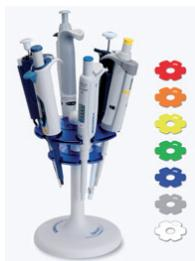
Support à 6 positions offrant une multitude d'avantages. C'est la solution de rangement idéale pour six pipettes monocanal, quelle que soit leur marque. Le support pivotant facilite la sélection des instruments et leur prise en main. Démontage en un éclair pour un entretien simple. Les plateaux interchangeables sont disponibles en sept couleurs translucides (rouge rubis, orange topaze, jaune citrine, vert émeraude, bleu saphir, gris quartz, blanc diamant).
