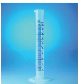
Conformes aux normes DIN 12681 et ISO 6706, classe B. Très transparents. Avec échelle graduée imprimée en bleu et en relief, graduations circulaires aux points principaux et socle hexagonal. Charges thermiques à +60°C et non permanents dépassements de la limite de tolérance.
