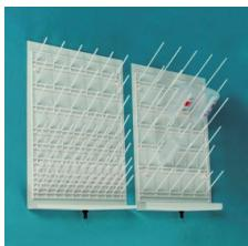
Blancs. Plaque murale et rigole entièrement en PVC. Rigole inclinée vers le centre et muni d'un dispositif d'écoulement. Cadre et tiges d'égouttage en métal plastifiés en polyéthylène. Le cadre est accroché à la plaque murale et peut être facilement retiré pour le nettoyage.
