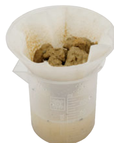
Étude de la porosité et de la perméabilité d'un sol
