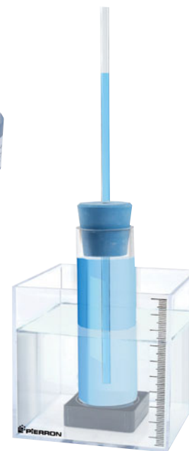
Mise en évidence de la dilatation thermique des océans et élévation du niveau marin
