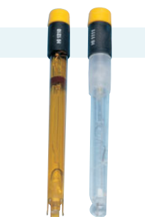
Deux types de corps d'électrode : en matière plastique (à gauche) et en verre (à droite).
