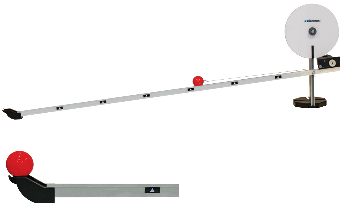
La bille positionnée sur la butée, pour l'étude du mouvement de translation uniformément ralenti.
