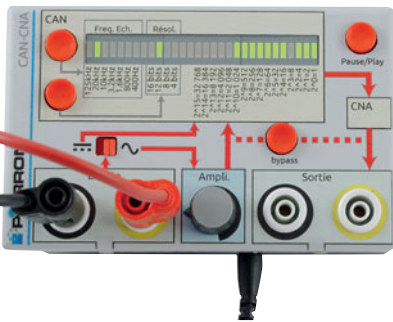
Mot binaire correspondant à 2,49 V (tension de référence : 5 V).
