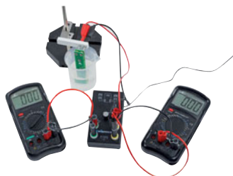
Mesure de la conductivité d'une solution avec 2 multimètres
