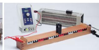
Vibration d'une corde parcourue par un courant alternatif au voisinage d'un aimant.
