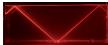
Réflexions multiples entre une surface en verre et la surface de l'eau.
