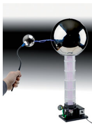
Étincelle entre la sphère principale et la sphère de décharge.
