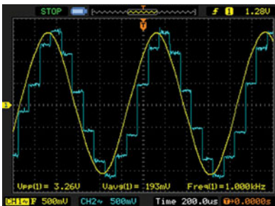
Signal de 1 kHz échantillonné à 10 kHz en 16 bits.
