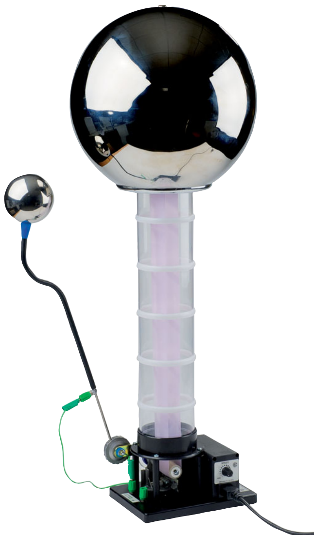
Étincelle entre la sphère principale et la sphère de décharge.
