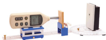
Étude de l'atténuation sonore (en dB) par un milieu absorbant
