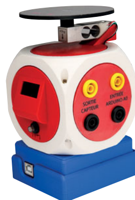
Le module dispose d'une sortie et d'une entrée analogique.
