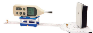
Étude de l'atténuation géométrique (en dB), radiale et angulaire
