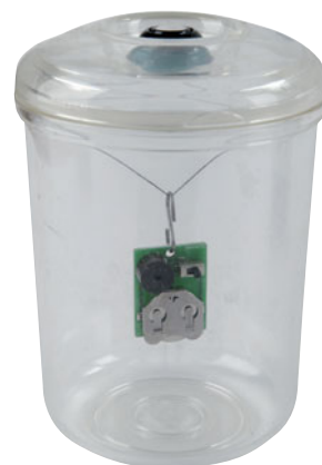
La sonnette suspendue à l'intérieur d'une cloche à vide.
