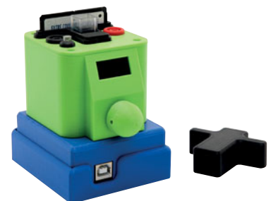
L'appareil permet d'utiliser des cuves et des filtres colorés standards.
