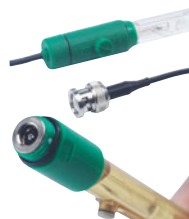
Deux types de connectiques : BNC (électrode sertie sur cordon terminé par une BNC, voir photo de gauche) ou à vis (connexion à vis sur laquelle s'adapte le cordon)
