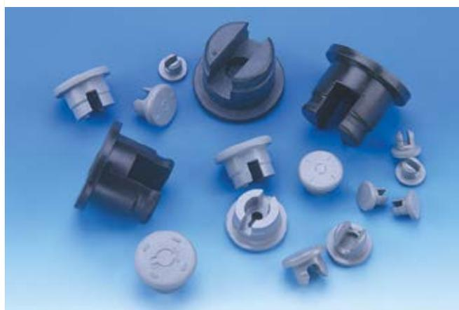
Bouchon fendu pour stockage sous vide ou gaz inerte. Le bouchon doit être partiellement introduit dans le flacon durant la lyophilisation, et totalement enfoncé en fin d'opération.
