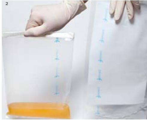
Photo 1 : sachets stériles ; de gauche à droite : - sachet stérile standard pour Stomacher® 400 ; - sachet stérile micro pour Stomacher® micro 80 ; - sachet stérile à fermeture pour Stomacher® 400 ; - sachet micro à fermeture ; - sachet standard pour Stomacher 400.
