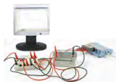
↑ Acquisition d'un cycle de charge et de décharge de l'accumulateur.
