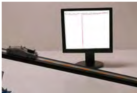
↑ Couplage de l'accéléromètre avec un banc mécanique
