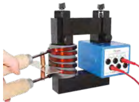
▲ Réalisation d'un point de soudure
