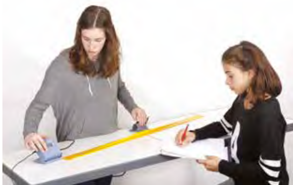
↑ Mesure du \Delta t avec la maquette vitesse du son non connectée
