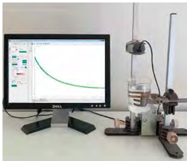
Montage permettant de modéliser la loi phénoménologique de Newton de refroidissement de l'eau
