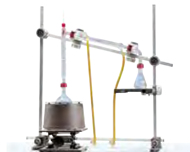
↑ Exemple de support pour montage de distillation fractionnée
