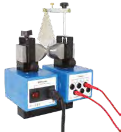
▲ Réalisation du freinage par courant de Foucault
