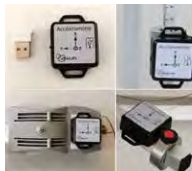
Accessoires fournis pour la fixation du capteur à différents montages
