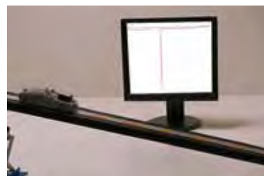
Couplage de l'accéléromètre avec un banc mécanique (ref 322082)
