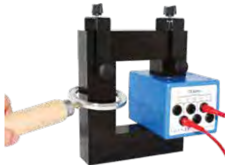
▲ Réalisation d'un chauffage par induction
