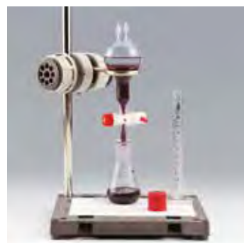
↑ Exemple de support pour montages légers particulièrement adapté pour la Microchimie (réalisé à partir du support Modumontage économique)
