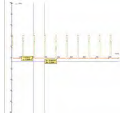
↑ Comparaison des signaux émis vers la diode laser en rouge et reçu par le récepteur optique en vert
