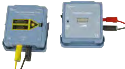
↑ Détermination de la distance maximale de transmission dans l'air
