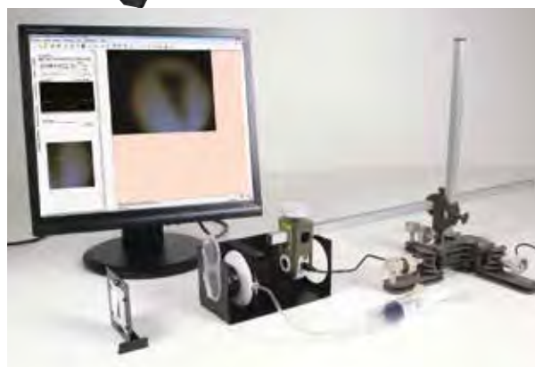
↑ Acquisition de l'image par une caméra dépourvue d'objectif.
