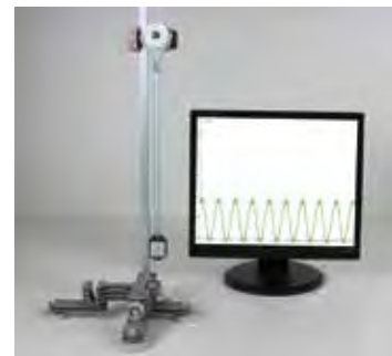
↑ Couplage de l'accéléromètre avec le pendule pesant
