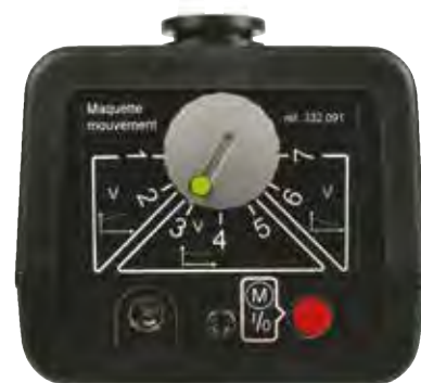
↑ Sélecteur de mouvement : accélérés, uniformes, décélérés
