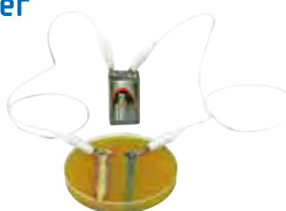
↑ Mise en évidence de la protection cathodique
