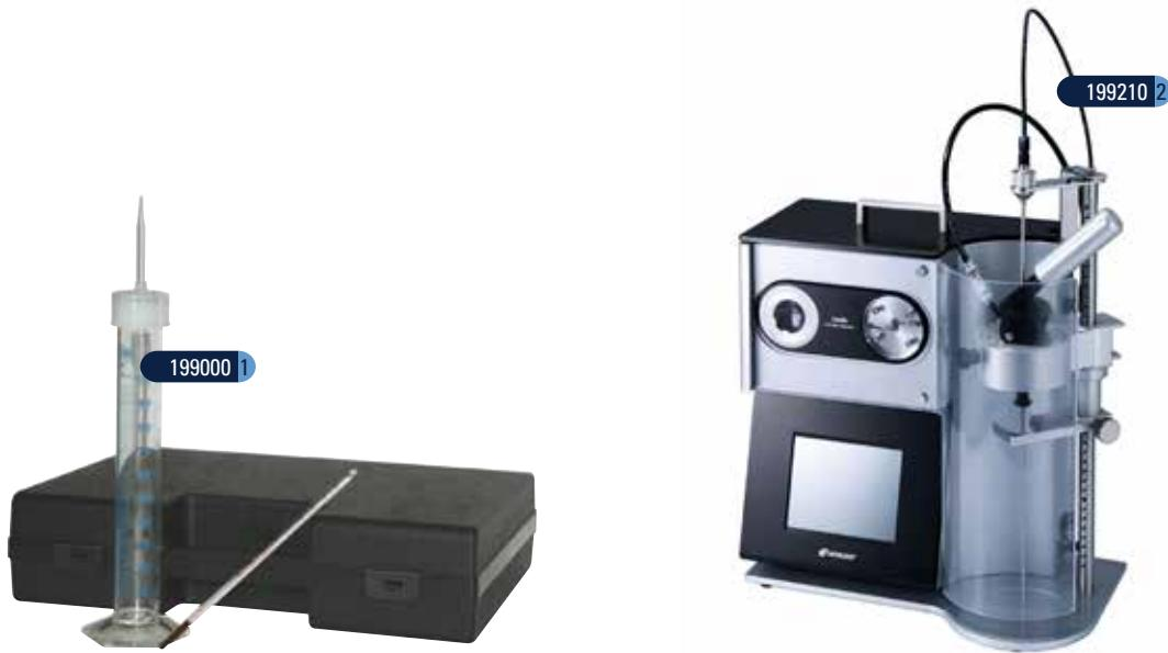
1 199000 **Carbodoseur.** Cette méthode est la plus simple et la plus adaptée au contrôle de chai du CO<sub>2</sub> dissous. Elle s'effectue à l'aide d'une éprouvette bouchée, préalablement remplie de l'échantillon à doser, qui une fois agitée laisse s'échapper un certain volume d'échantillon, en relation avec la teneur en CO<sub>2</sub>. Précision de l'ordre de 50 mg/l. Livré complet en mallette avec table de correspondance.
