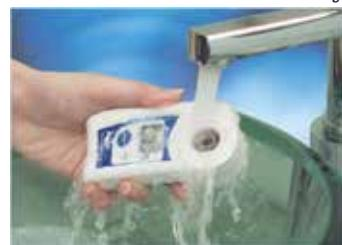
Rinçage des réfractomètres PAL
