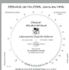
La pression atmosphérique et l'altitude influencent le point d'ébullition. Une calibration est donc nécessaire pour déterminer les conditions de l'environnement au moment de la mesure. Ainsi, la première étape consiste à mesurer le point d'ébullition de l'eau ou d'un vin étalon pour ajuster la table de correspondance "point d'ébullition/degré alcoolique". Le point d'ébullition de l'échantillon peut alors être mesuré et reporté sur la table de correspondance pour connaître le degré alcoolique.
