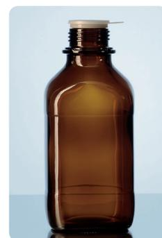
En verre sodocalcique. Filetage en forme haute. Une température maximale en utilisation de +100 °C est recommandée. Résistance aux chocs thermiques 30 K. Classe hydrolytique 3.
