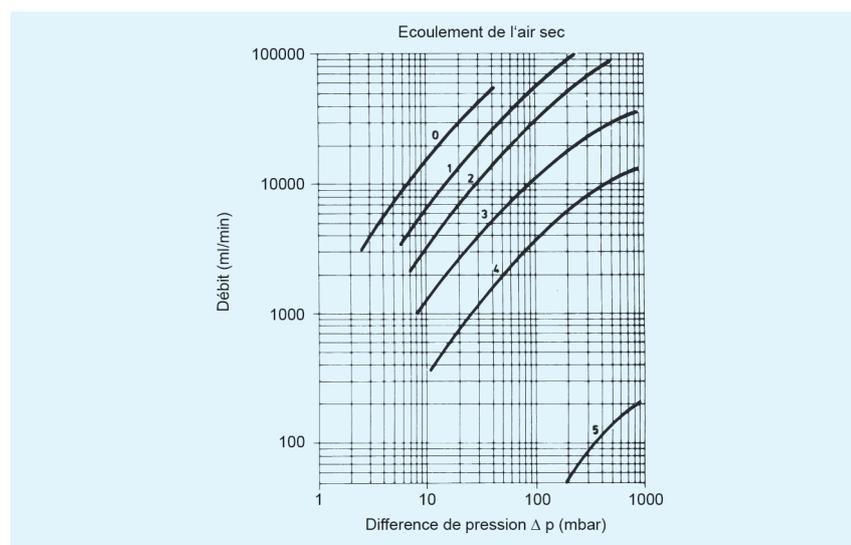
Ecoulement de l'air pour des plaques filtrantes de porosité différente en fonction de la différence de pression. Ces indications s'appliquent à des plaques filtrantes d'un diamètre de 30 mm.
