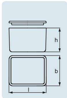
Remarque : ne pas nettoyer les cuves et cuvettes de coloration à plus de 60 °C (risque de corrosion du verre).
