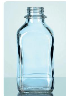
Filetage en forme haute. Une température maximale en utilisation de +100 °C est recommandée. Résistance aux chocs thermiques 30 K. Classe hydrolytique 3.
