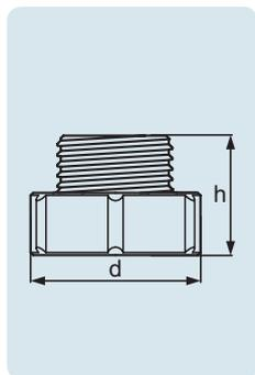
L'adaptateur réutilisable (extérieur GL 45, intérieur GL 56) permet de raccorder le flacon DURAN® TILT à l'unité de filtration sous vide. L'adaptateur est réalisé en PTFE inerte et peut être autoclavé à 300 °C, et stérilisé.
