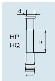
Surface de palier rodée et polie, avec joint mâle à rodage standard.
