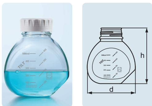
Le flacon DURAN® TILT est le seul flacon de culture de cellules pouvant être utilisé dans deux positions : il peut être utilisé en position verticale pour la stérilisation par filtrage et incliné à 45° pour faciliter le pipetage. Il est particulièrement adapté au travail avec des cultures de cellules en conditions stériles dans les enceintes de sécurité biologique et les hottes à flux laminaire.
