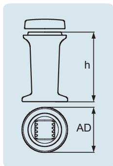
Pour 10 lames 76 x 26 mm. Remarque : ne pas nettoyer les cuves et cuvettes de coloration à plus de 60°C (risque de corrosion du verre).
