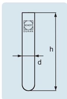
Les tubes à centrifuger en verre sont donc très résistants à la sollicitation mécanique. La partie du produit de densité élevée se concentre au fond. De ce fait, il est possible de collecter et de séparer également des faibles quantités de matières solides.
