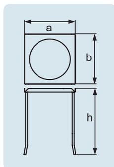
Porte-plaque pour plaques en vitrocéramique. En acier inoxydable résistant aux températures, très bonne stabilité grâce aux quatre pieds et construction solide.
