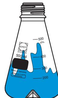
Lors de l'utilisation de fioles Erlenmeyer DURAN® sur un agitateur, le mouvement provoque le développement d'un film liquide en forme de faucille. La fiole avec déflecteurs DURAN®, pourvue de quatre déflecteurs sur le fond, interrompt l'écoulement laminaire et génère un écoulement turbulent. La surface du liquide et la surface d'échange des gaz augmentent ce qui a pour conséquence une introduction d'oxygène plus importante.
