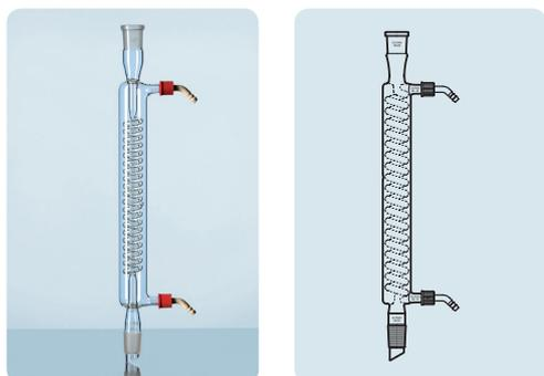
Exemple d'applications : réfrigérant de produit pour décanter le distillat.
