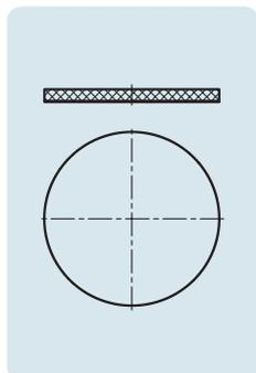
Septum en silicone revêtu de PTFE à utiliser avec le capuchon à visser ouvert sur le dessus DURAN® GL 45 et les flacons de laboratoire DURAN® GL 45 de toutes tailles. Peut être utilisé pour l'ajout, l'inoculation ou le prélèvement d'échantillon à l'aide d'une seringue et d'une aiguille. Idéal pour les laboratoires de chimie, de biologie et biopharmaceutiques.
