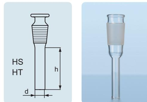
Surface de palier rodée et polie, avec tube fileté et joint mâle à rodage standard.
