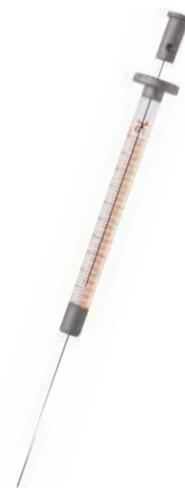
**Microseringue Type X pour passeur d'échantillons PAL**
